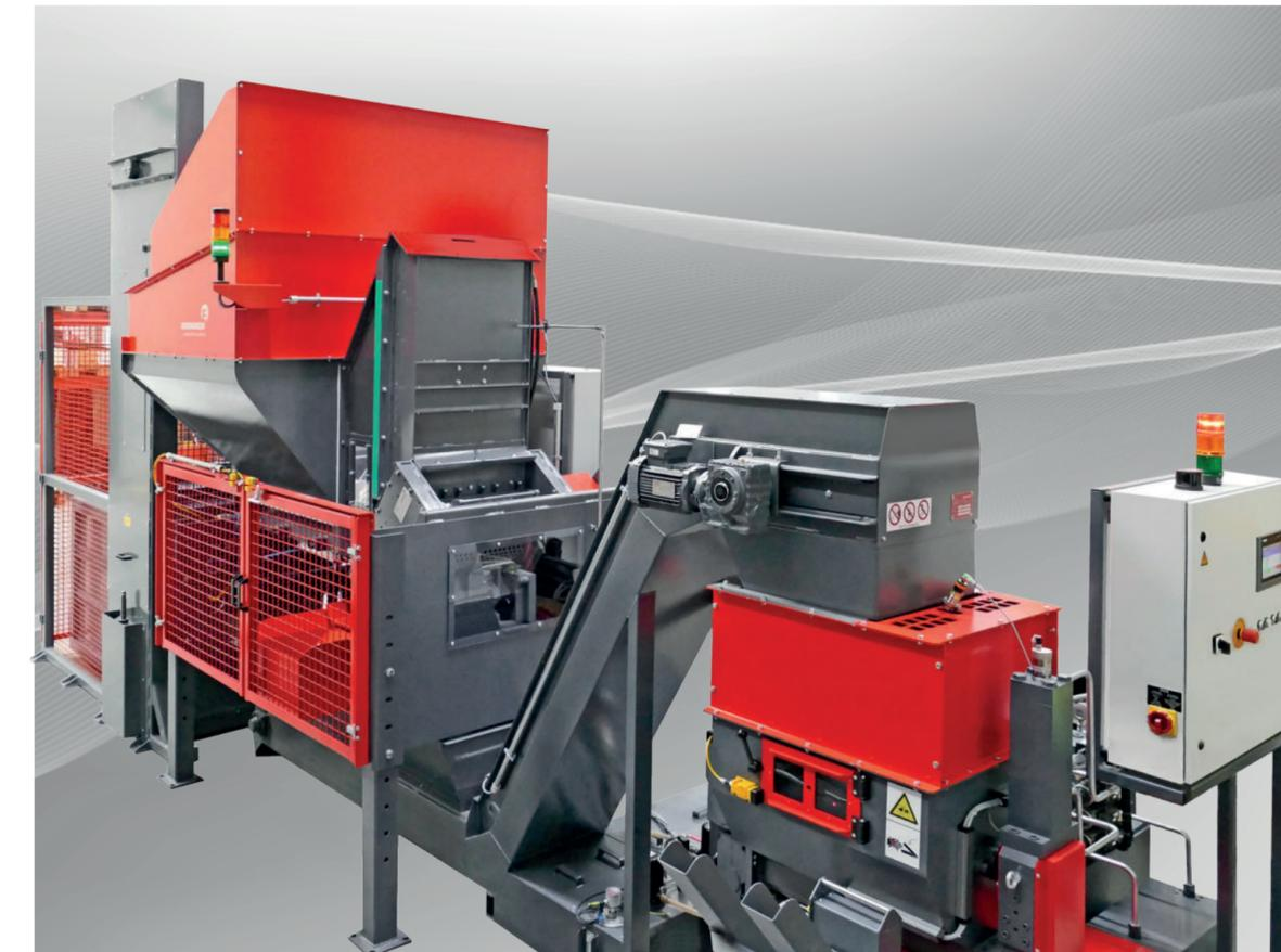
Die Entwicklung der innovativen M600/1-600-3S Zerkleinerungsmaschine mit Schneckenführung und integriertem Störstoffhandling basiert auf langjähriger praktischer Erfahrung. Voluminöse Spänegewölle sind das Resultat der teilweise sehr großen Zuführmengen. Die gewonnenen Erkenntnisse aus Zerkleinerung problematischer Massivteilen trägt unserer Professionalität bei.
