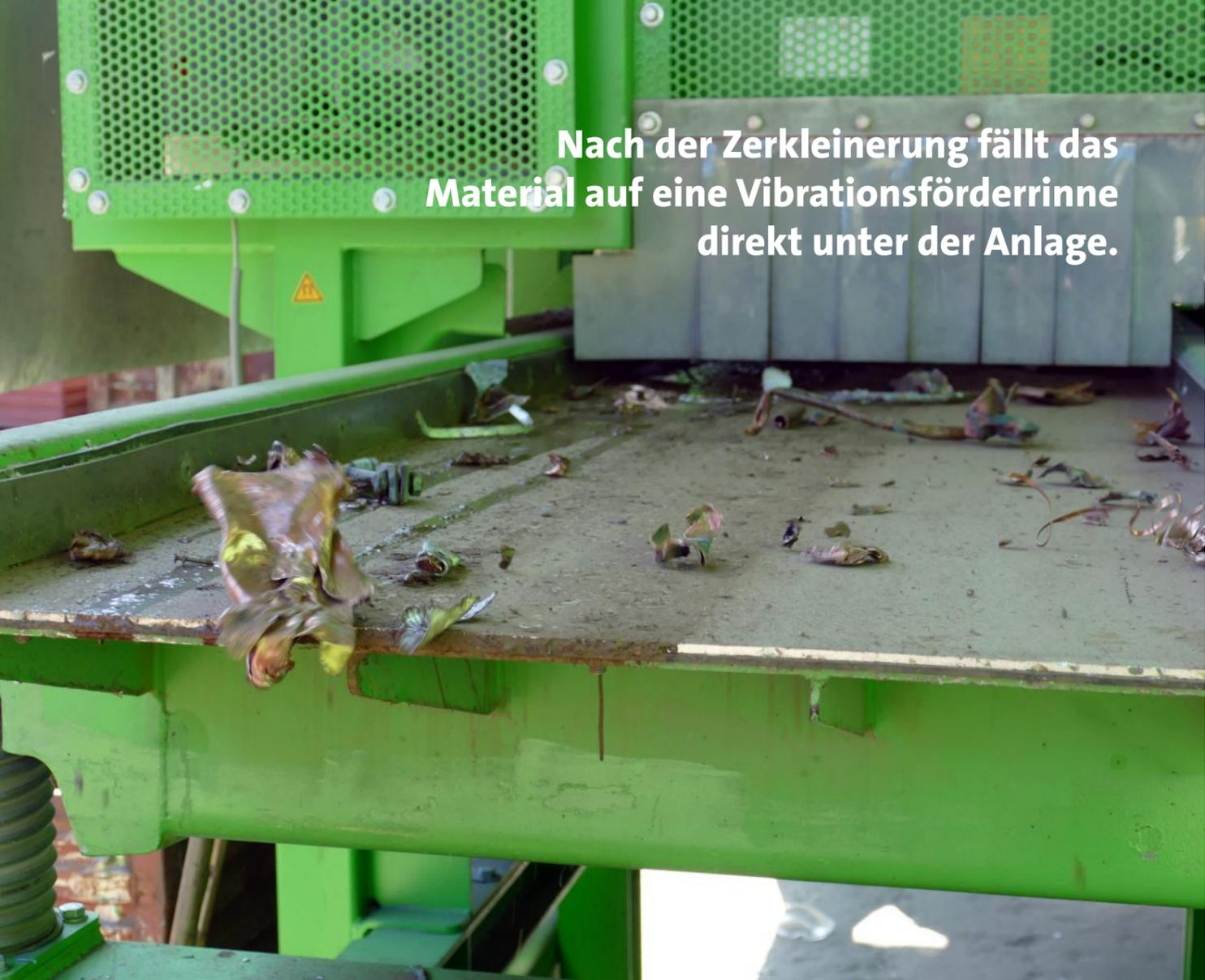
Nach der Zerkleinerung fällt das Material auf eine Vibrationsförderrinne direkt unter der Anlage.
